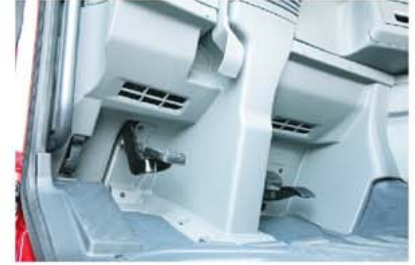
脚部风道出口 Air Outlet
