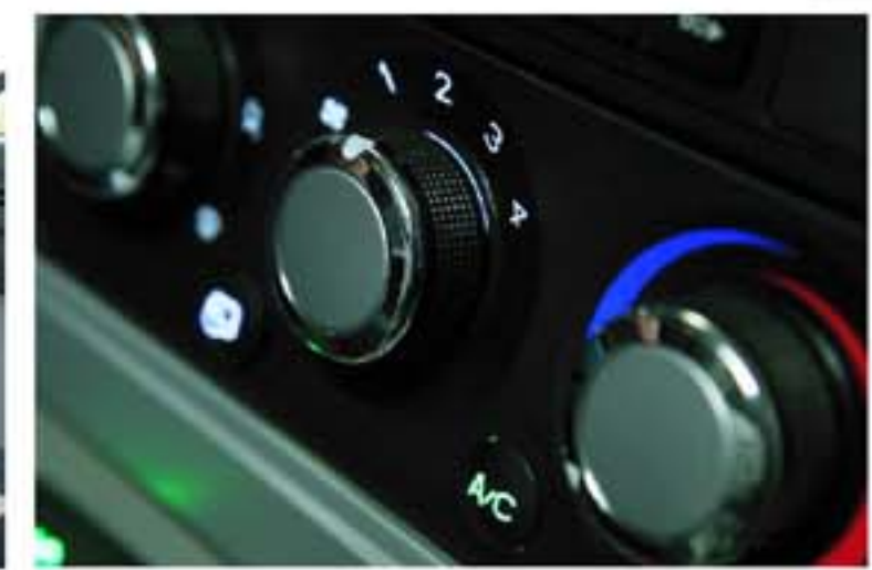
空调控制开关 A/C Panel
