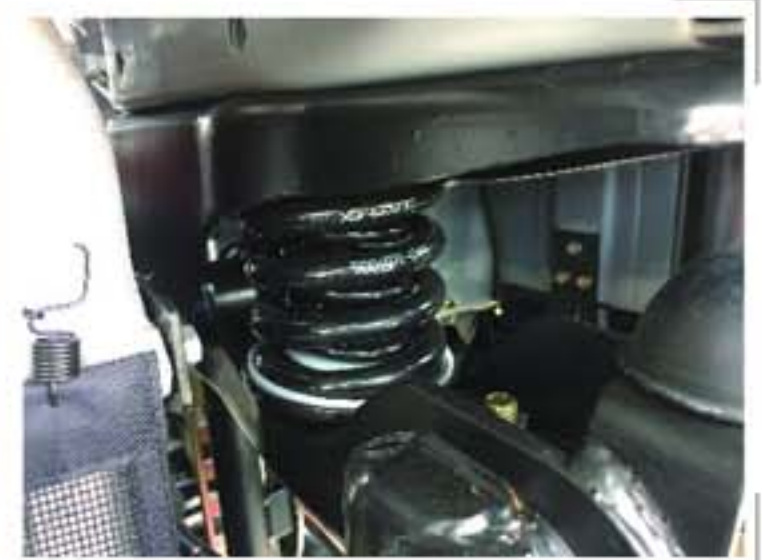
全浮驾驶室（前悬） Full-float Cabin (Front Suspension)
