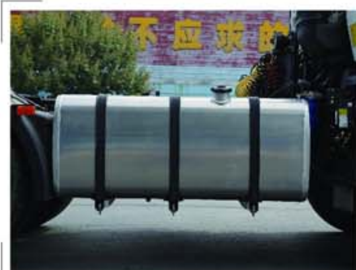
600L铝油箱 600L Aluminum Fuel Tank
